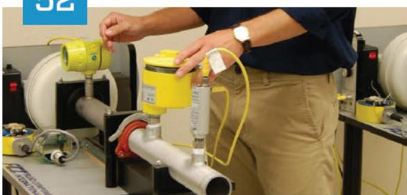
Måling av våt eller fuktig gass, med termisk massemåler fra FCI
